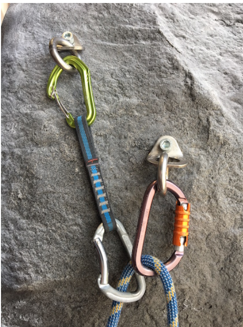
Exempel 1: Borrbultsankare bestående av två hängare försedda med fasta ringar.
